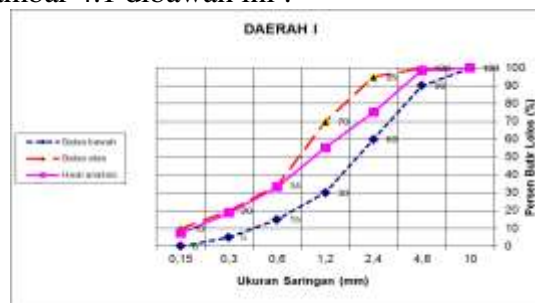
Gambar 3. Grafik hasil analisis saringan agregat halus (daerah I) dari limbah beton
